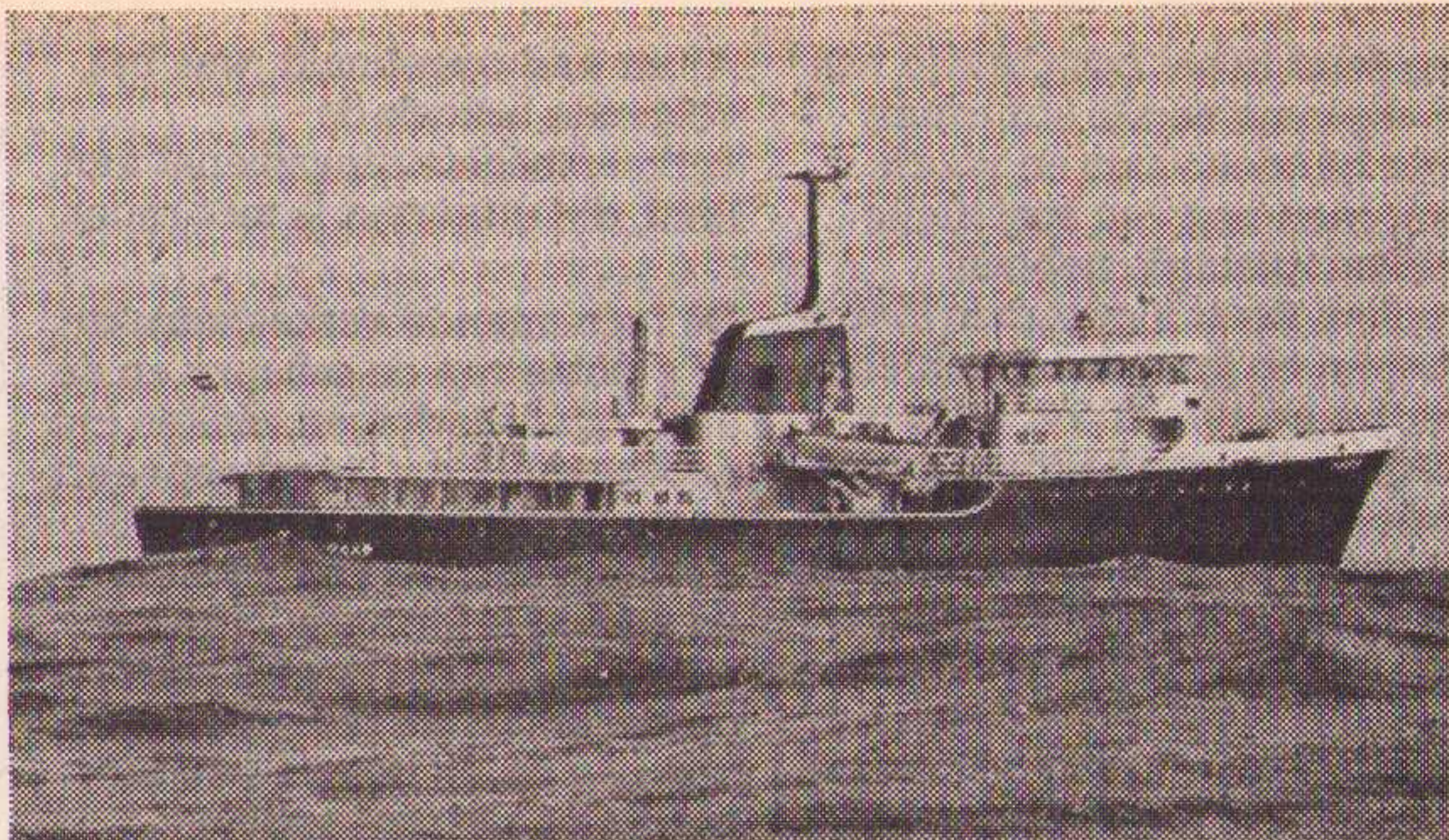
Loodsvaartuig met loodsjol aan de zijkant
